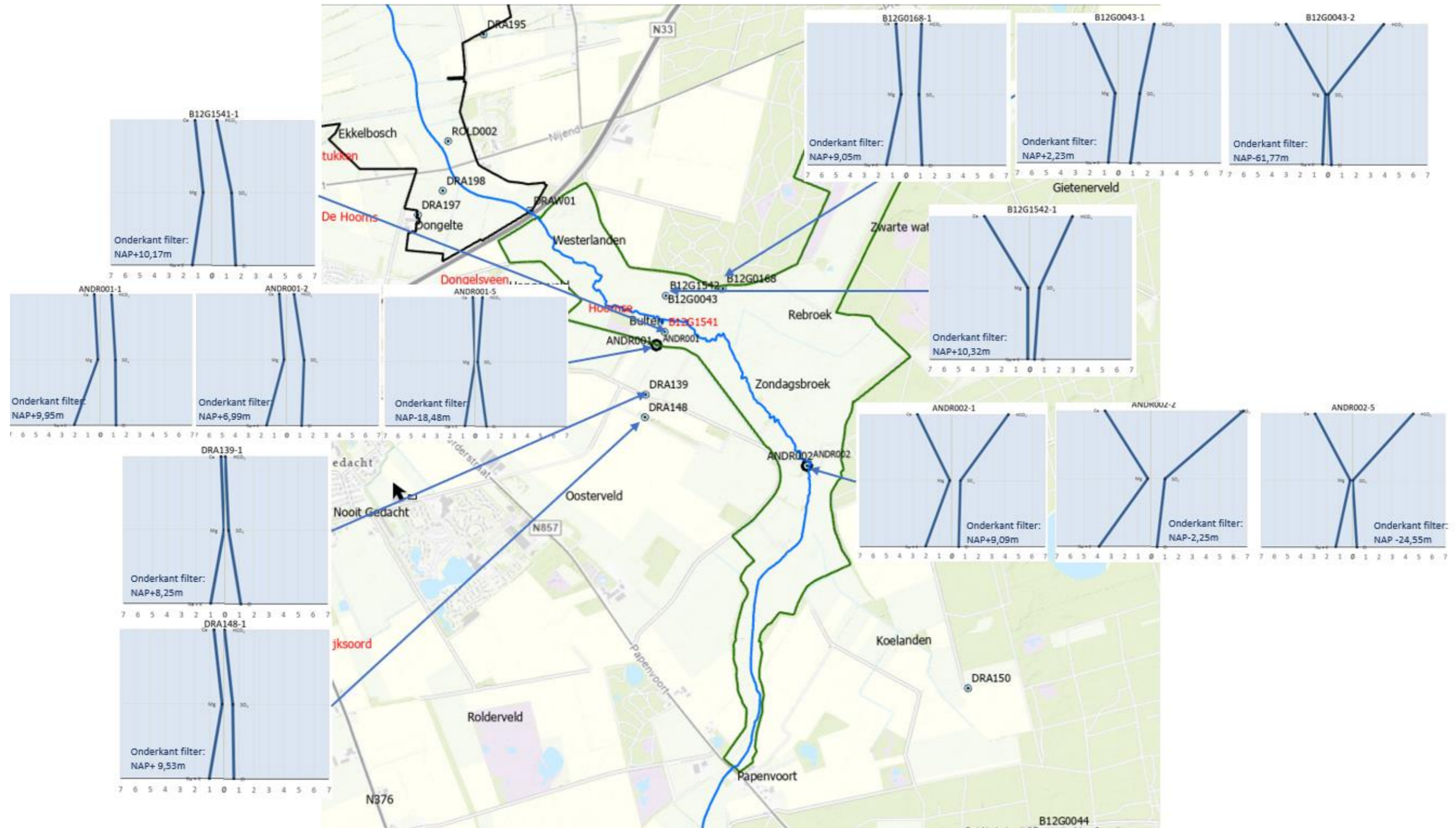
Figuur 2-15. Stiff diagrammen Andersche diep (opbouw van de figuren zijn als volgt: linksboven Ca, rechtsboven HCO3, midden links Mg, midden rechts SO4, onder links Na + Ka en onder rechts Cl).
