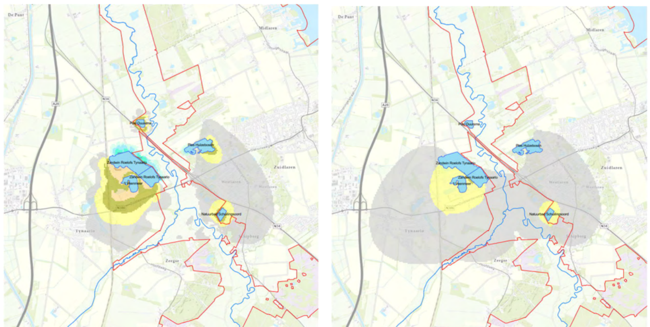
Figuur 5-4 Effecten na realisatie zandwinningen, met plas Roelofs op hoog peil (na 1995) op het freatische grondwater (links) en het watervoerende pakket onder de Peelo formatie (rechts). Situatie zonder bodemweerstand
